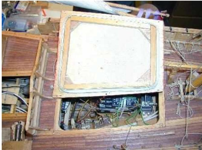
Damit man den Deckel einfach aufstecken und herunternehmen kann wird die Dichtung mit Fett eingerieben. Wir haben dazu Hirschtalg, der z.B. als Gleitmittel von Autotüregummis dient, verwendet und in jedem Fahrzeug-Zubehörladen zu bekommen ist.
