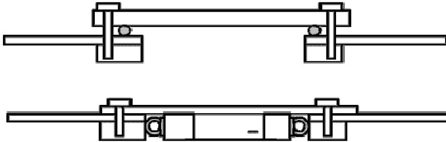
Die ober Skizze ist die Lösung der U-Bootfahrer, die unten mit dem D-Profil ist unsere (Dichtungen grau ausgefüllt).
