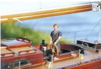
Der Großmast, Fockbaum und Großbaum stellte ich aus Merantiholz her. es wirkt in seiner rötlichen Farbe passend zum Mahagonirumpf. Das stehende Gut besteht aus 0,8 mm Stahlseilen, welches mit Kunststoff ummantelt ist. Die Relingsstützen stecken in eingelassenen Metallhülsen, so daß sie herausnehmbar sind. Dies hat den Vorteil, daß sie bei eventueller Deckslackierung nicht Wege stehen (man weiß ja nie!). Die Wassertropfen an der Reeling rühren von einer stürmischen Fahrt her.
