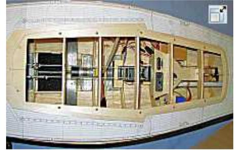
die Schalter mit Ladebuchsen werden später unter der herausnehmbaren Sitzbank liegen und so zugänglich sein, ohne abtakeln zu müssen.
