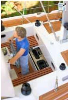
Bild 11 – Versteck für Schalter und Ladebuchsen
