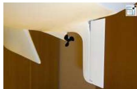
Das Ruderblatt selbst ist aus zwei 1-mm-ABS-Platten hergestellt, zwischen die eine Stahlstange (gekürzte Schiffswelle) mit Stabilit-Express eingeklebt wurde.
