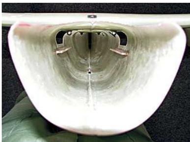
Hulls (Rümpfe) und Beams (Querträger) sind aus GFK (Glasfaserkunststoff) gefertigt, alle Hochbelasteten Teile (Mast, Bäume, Schwert, Ruder und Ruderpinne aus CFK (Kohlefaserkunststoff). Hulls und Beams sind mittels Pass-Stiften und Schrauben verbunden und somit demontierbar. Das segelfertige Gesamtgewicht beträgt incl. Fernsteuerung und Akkus gerade mal 2.900 Gramm!
