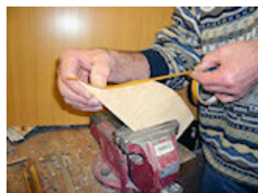
beidseitiges Klebeband aufbringen
