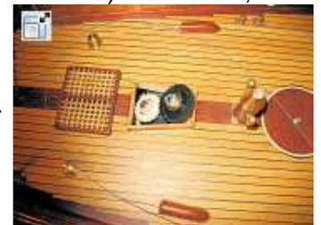
Alle Teile der Technik sind so platziert worden, dass sie durch die Serviceöffnungen im Deck zu erreichen sind. Ich muss zugeben, dass bei der Wartung mancher Teile eine Verrenkung der Hände unausweichlich ist. Auch ist das Servo vor dem Schonermast nicht mehr zu erreichen, aber ich hoffe, dass es wegen der relativ geringen Belastung „ewig“ hält. (Mir ist noch nie ein Servo kaputt gegangen, daher meine Zuver-sicht!).
