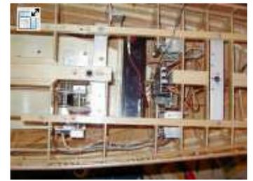
Die Segel der Yacht sollten über zwei Segel-winden und ein Servo mit verlän-gertem Hebel gestellt werden. Das Servo war für den Aussen-klüver vorgese-hen. Es wurde im Rumpf unmittelbar vor dem Schonermast befestigt. Die Schot fährt auch vor dem Schonermast zum Aussenklüver hoch. Das Servo wird über einen 1-0-2 Schaltkanal angesteuert, somit ist der Aussenklüver in Pos. 1 dicht geholt und in Pos. 0 und 2 gefiert.
