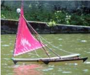
Bild 27: Der Ausleger liegt wieder auf dem Wasser. Die Winde zieht den Mast wieder in die Senkrechte. Das Segel kommt wieder aus dem Wasser heraus.
