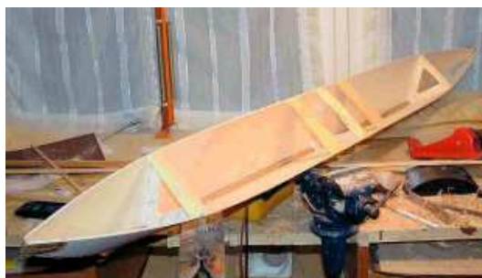
Bild 08 Der Ausleger im Rohbau
