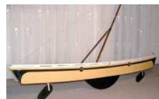
Bild 09 Das Schwert in der Mitte des Rumpfes; "vorne" und "achtern" je ein Ruder
