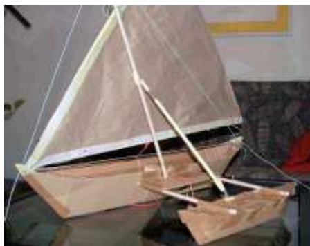
Bild 05 und Bild 06 Pappmodell für die ersten Gedanken Segel-Umsteuerung "über Kopf"
