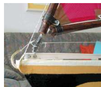
Bild 10 Der Fußpunkt des Dreiecksegels, mit einer Gardinenrolle beweglich an einer Schiene befestigt
