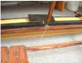
Bild 19: das Seil führt durch das „Außen-Rohr“ des Teleskop-Stützastes hindurch und ist am unteren Ende des Innen-Rohres befestigt. Durch Ab- bzw. Aufwickeln des Seiles wird der Stützast teleskopartig verlängert bzw. verkürzt
