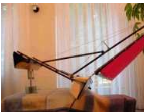
Bild 22: Größere Krängung: Stützast „ausgefahren“ (länger), der Mast steht dadurch nicht mehr senkrecht zur Schiffsebene, sondern neigt sich nach Lee
