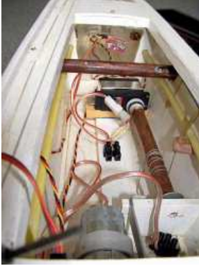
Bild 18: Die Winde für den Teleskop-Stützmast: ein Rundholz-Stab an einer Segelwinde. Im Hintergrund ist als rotes Bauteil der um etwa 200 geneigte Lageregler zu erkennen. Er tritt in Aktion, sobald er durch die Krängung des Bootes waagrecht liegt bzw. sich nach der anderen Seite neigt.
