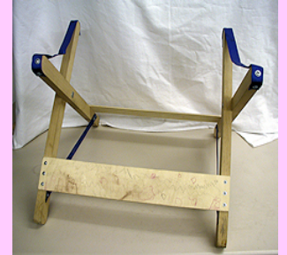
Bild 4.1: Ein entsprechend den Angaben aus vielen Baukästen gefertigter Bootsständer, hier durch Kinderhand reichlich „verziert“. Diese Ausführung kann man allenfalls als eine Notlösung für kleine und leichte Modelle mit einem langen fest installierten Schwert akzeptieren.
