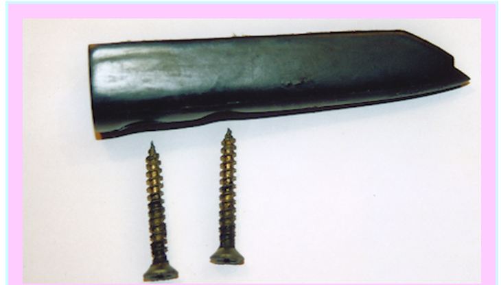
Bild 6.15: Diese Abdeckkappe wurde aus Holz angefertigt, doch auch andere Werkstoffe sind denkbar.
