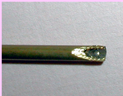
Bild 11.4: Jetzt arbeiten Sie mit der Rundfeile des Schlüsselfeilensatzes in die Schnittstelle entsprechend des Außenradius der Relingstütze eine Rundung nach innen ein (eine Hohlkehle).
