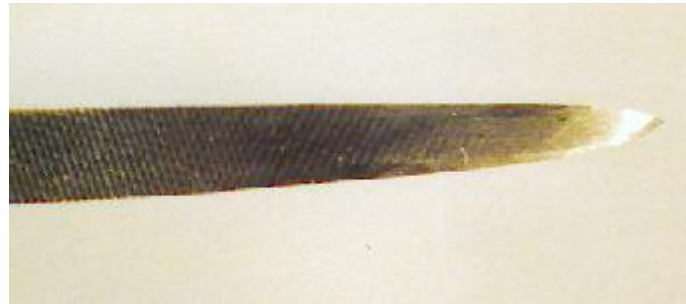
Bild 6.18: Einen Mini-Dreikantschaber kann man sich selbst aus einer kleinen Dreikant-Schlüsselfeile anschleifen.
